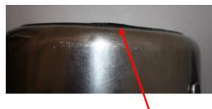
Oddělení dna pánví a nádob přehřátím / vařením sucho
